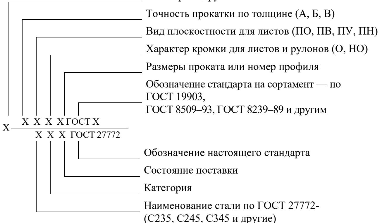
Прокат горячекатаный листовой повышенной точности (А), высокой плоскостности (ПВ), с обрезной кромкой (О), размерами ( $10 \times 1000 \times 2000$ ) мм по ГОСТ 19903, из стали С390, в улучшенном состоянии (У), категории 6:
