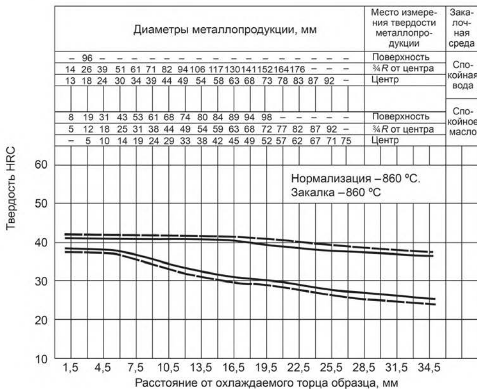
Рисунок А.17 — Сталь марки 12Х2Н4А
