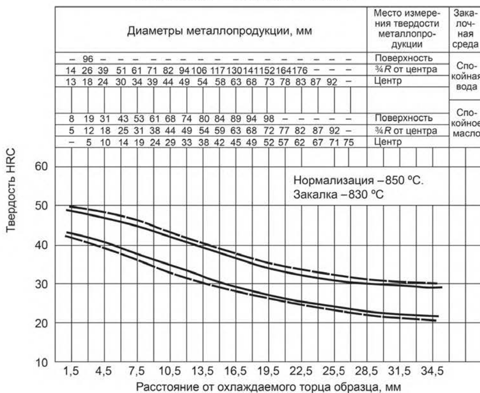
Рисунок А.16 — Сталь марки 20ХН3А
